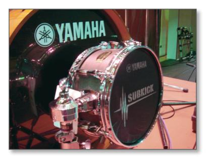
超低音的能量補償與應用,在現場被發現是這麼的重要與必須,一些針對低頻延伸的輔助工具也不斷的問世,在鼓組樂器裡的大鼓收音,他除了基本的麥克風拾音以外,另外再提供一只低頻提升 SubKick元件,也等於在通道上會再增加一個聲音迴路,不過這個聲音內容是一個純低頻厚實的訊號,方便使用者快速得到一個可用的低頻訊號。
